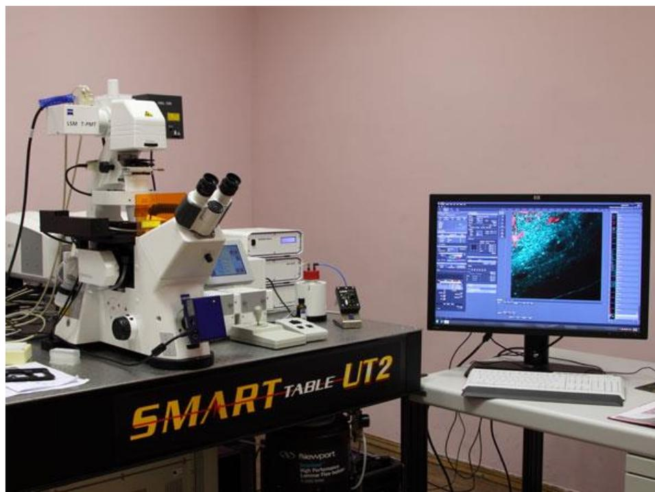
Рисунок 28. Лазерный сканирующий микроскоп LSM-710-NLO.
