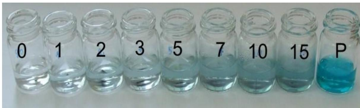
*Рисунок 18. Коллоидные растворы НЧ-AlPc, полученные при различной длительности диспергации (значение указано на рисунке). Также показана суспензия крупнодисперсного AlPc (исходный раствор, использовавшийся для приготовления наночастиц, обозначен 0) и раствор сульфированного (водорастворимого) AlPc (обозначен P). Все растворы имеют концентрацию 100 мг/л.*
